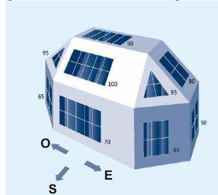
Figure 3 distribution de la lumière solaire reçue sur les façades et les toits des bâtiments
