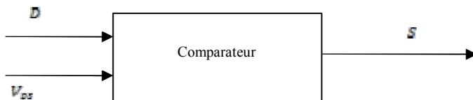
Fig. 6 Principe du PWM
