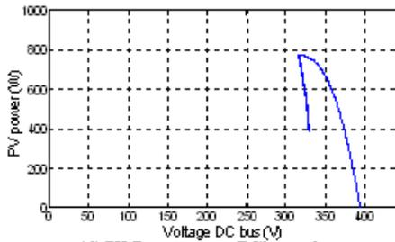
(d) PV Power versus DC bus voltage
