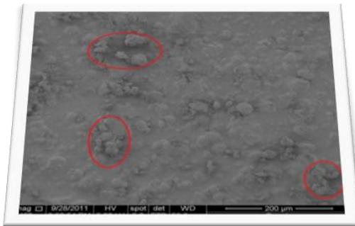
Figure 6 : surface TiO<sub>2</sub> avant recuit.
