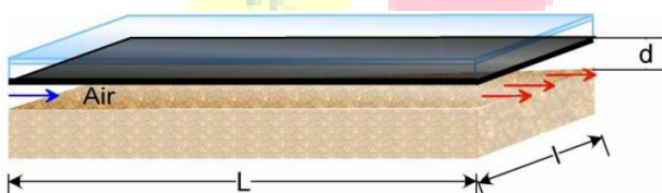
Fig. 1 Description et dimensions du capteur solaire.
