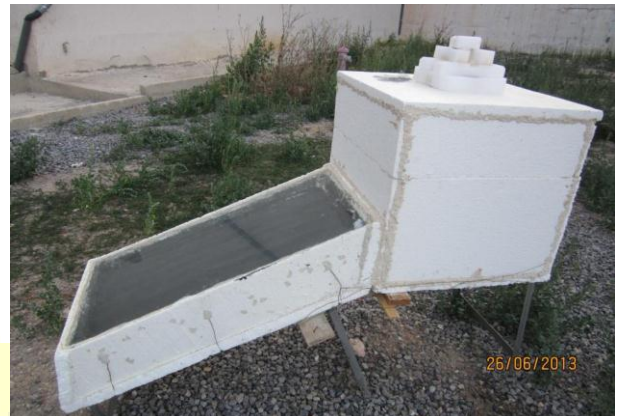
Fig. 2 Sécheur solaire indirecte à convection naturelle.
